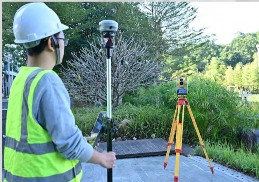
RTK GO 2025 ahora permite a los supervisores trabajar conjuntamente con el receptor GNSS y la estación total robótica. Cuando se instala un receptor GNSS en el poste del prisma, la estación total robótica puede rastrear el prisma con mayor eficiencia mediante el uso de datos GNSS, es de gran ayuda cuando trabaja en terrenos complicados y el prisma a veces está bloqueado.
